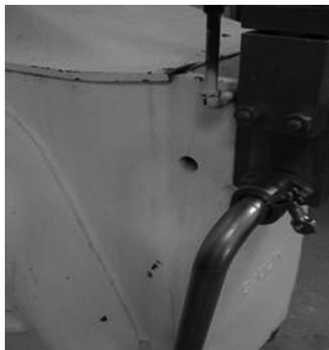
Figura 21 Fuga de Agua en Homogenizador
